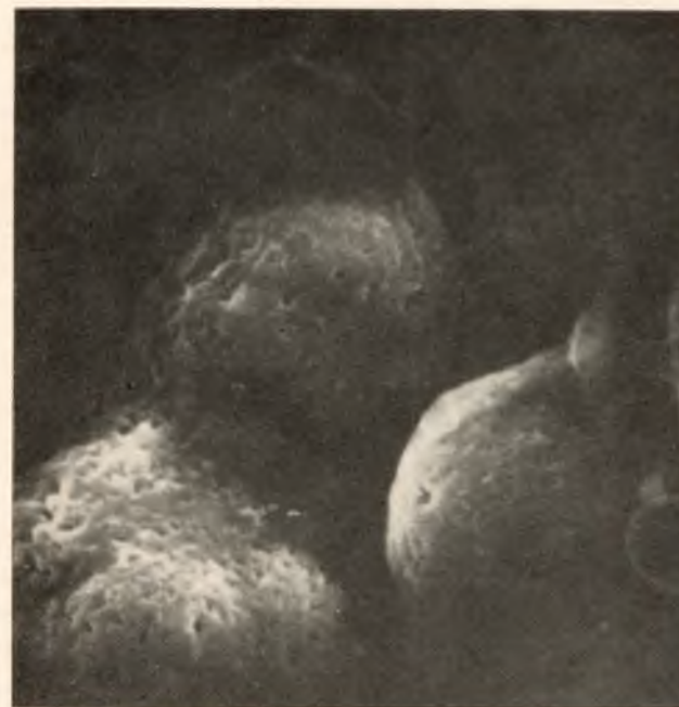
Ryc. 4. Fragment powierzchni metal u pokryty chlorkami przy pow. 4800×
