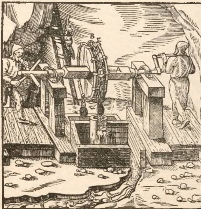
Ryc. 3. Prototyp pompy wodnej zwanej kafarem lub „paternostrem”, wg G. Agricoli
