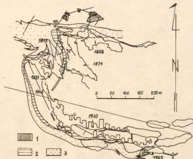
Ryc. 14. Plan komór „Seeling”, „Elżbieta”, „Sermage” i komór ługowniczych wybranych w solach szybikowych kopulasto uformowanej łuski północnej, w IV poziomie kopalni
