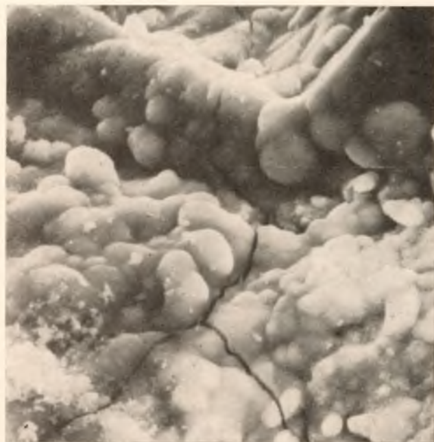
Ryc. 3. Fragment powierzchni metal u pokryty chlorkami. Widoczne mikroszczeliny. Pow. 1900×
