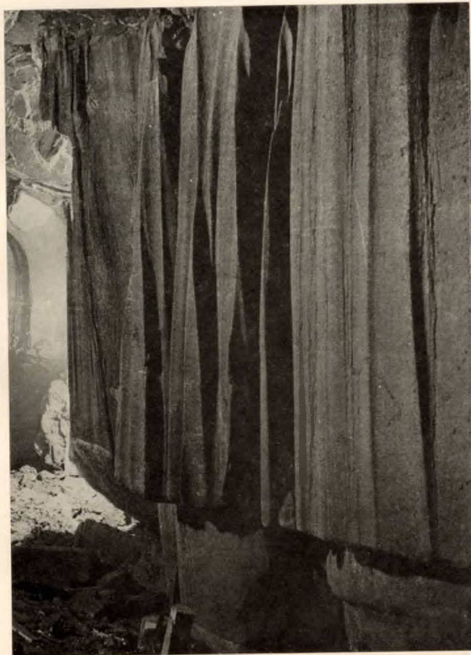
Ryc. 7. Eksploatacja ługowaniem (ocios odbudowany „zraszaniem”)
