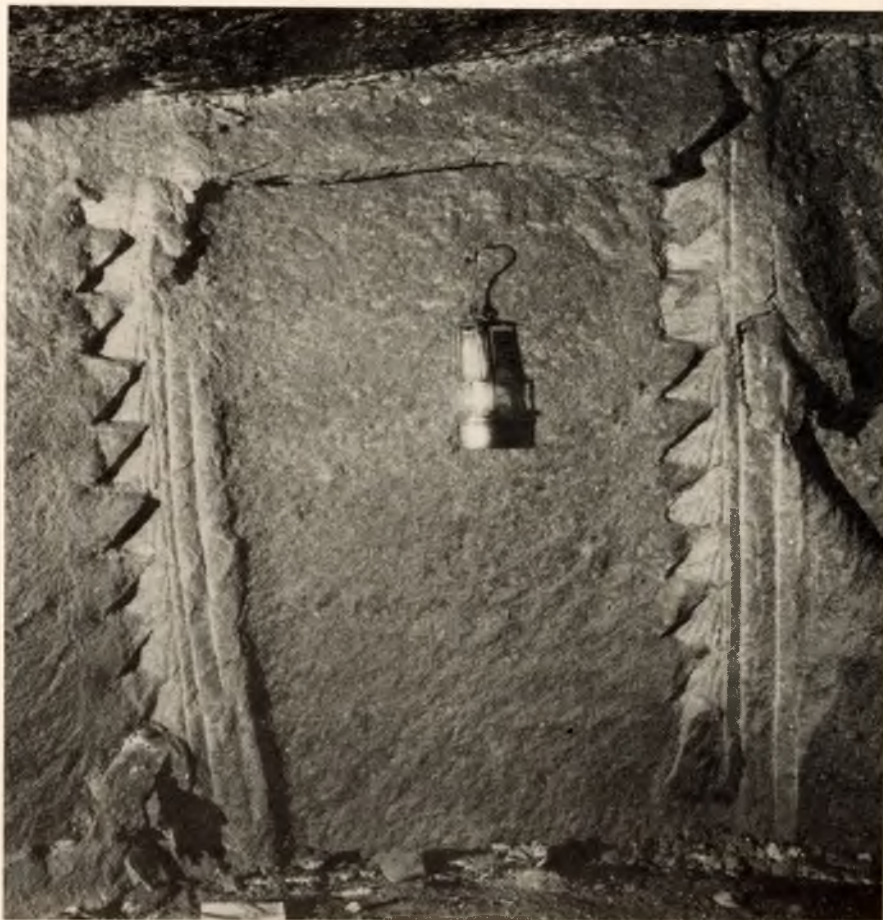
Ryc. 8. Eksploatacja ręczna (śląd po zbiciu kłapcia)
