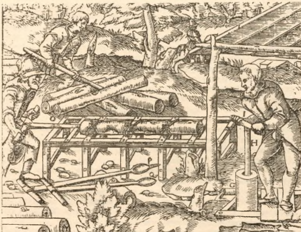
Ryc. 2. Wykonywanie rur drewnianych, wg G. Agricoli
