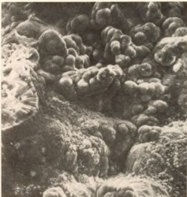
Ryc. 2. Produkty korozji na powierzchni metalu. SEM. Pow. 900×
