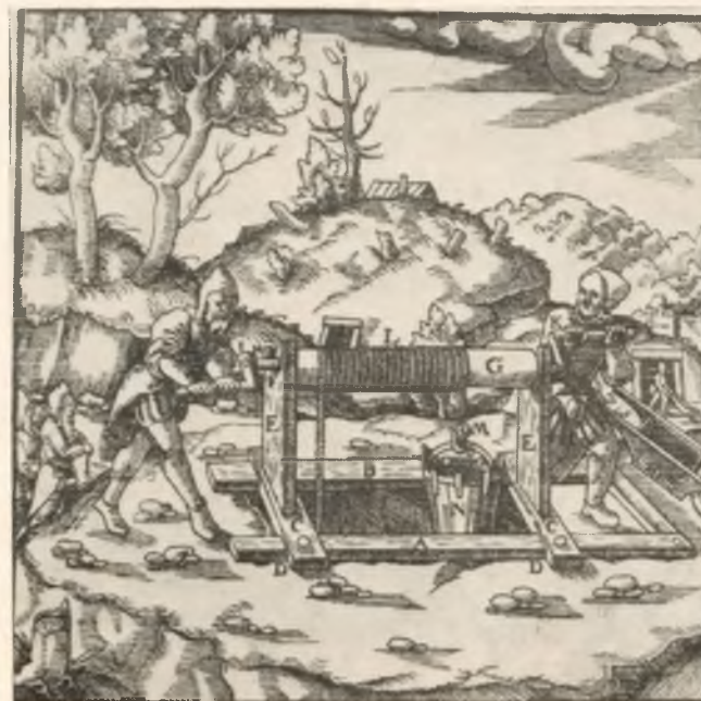
Fot. 1. Kołowrót korbowy (z wałem ciernym) z XVI w. (wg G. Agricoli)
