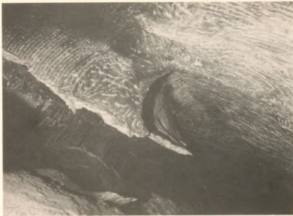
Fot. 3. Ślady roboty kawernowej w komorze „Zaporów”
