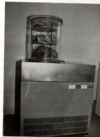
Fot. 3. Zabytki drewniane poddawane sublimacji w aparaturze próżniowej
