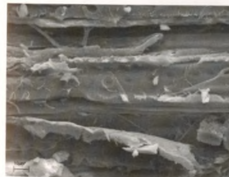
Drewno sosny – biel, próbka 6, przebywające w soli miałkiej prawdopodobnie od lat 60-tych XX w. Przekrój styczny, widoczne kubiczne kryształy soli, drewno rozwłóknione
