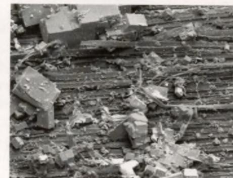
Drewno sosny – twardziel, próbka 6, przebywające w soli miałkiej prawdopodobnie od lat 60-tych XX w. Przekrój promieniowy, jamki lejkowate i ściana pokryte solą
