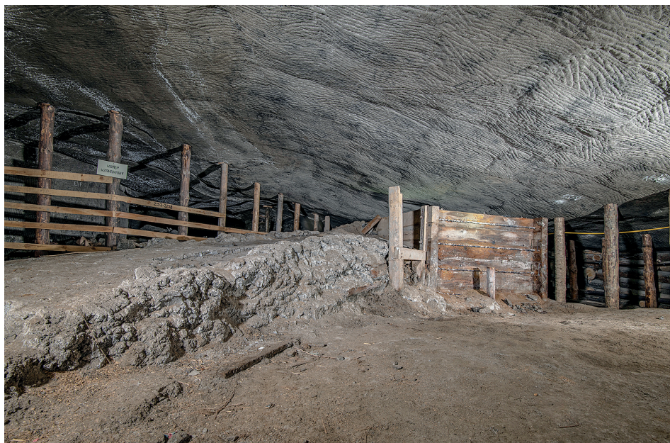
6. Skrzynia ługownicza w chodniku do kanału Leopolda, fot. D. Kołakowski, 2022
