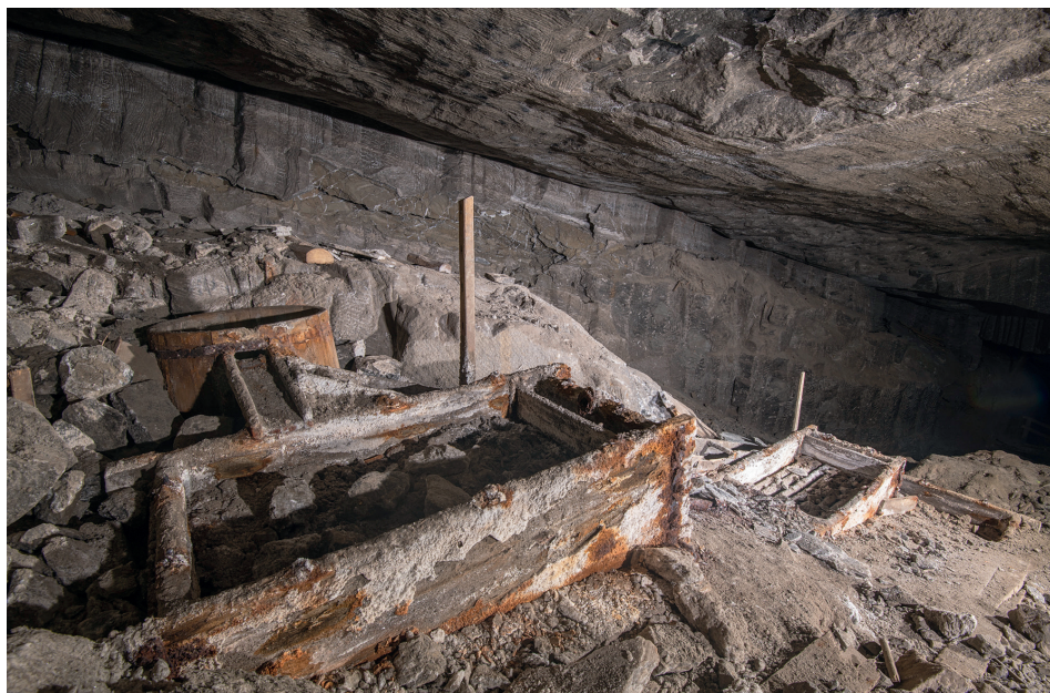
5. System dosycania solanki w komorze Elżbieta z wycieku w chodniku Wasserstrecke Seeling, fot. D. Kolakowski, 2023
