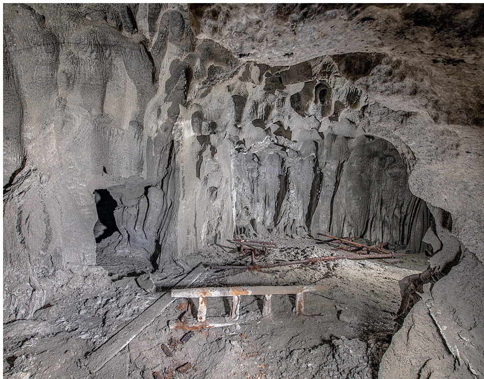
9. Jedna z komór eksploatowana systemem natryskowym w ciągu komór natryskowych powyżej poziomu IV KSW przy południowej granicy złoża, fot. D. Kolakowski, 2022
